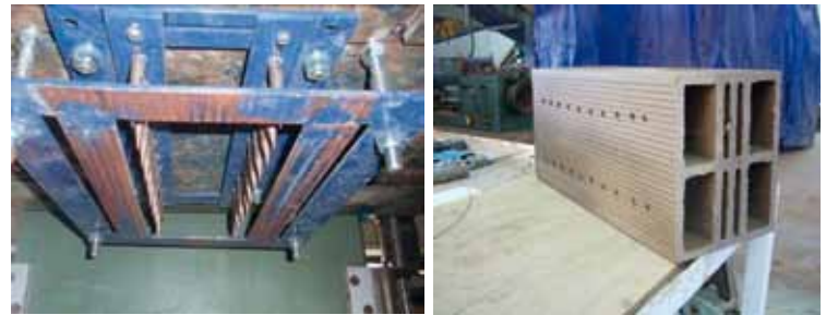
Dispositivos para el perforado lateral de piezas y pieza final
