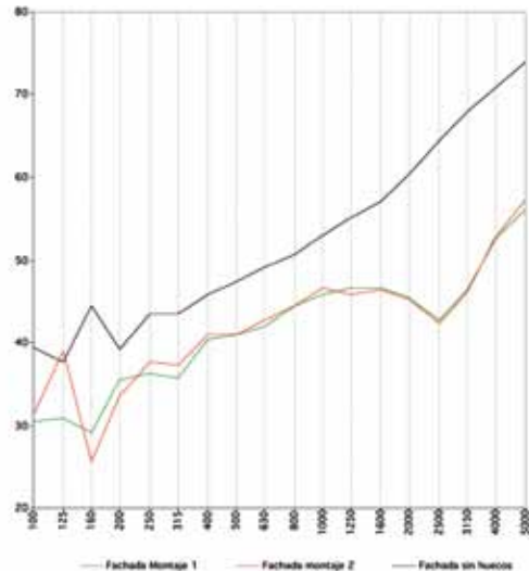
Figura 12. Comparativa curvas de aislamiento acústico en los montajes 1, 2 y fachada ciega Figura 13. Mapa por intensimetría del ensayo del Montaje 1. Apoyo rígido (estándar) Resultado total Figura 14. Mapa por intensimetría del ensayo del Montaje 2 : Apoyo elástico. Resultado total
