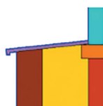
Figura 5: Puentes térmico lineal del encuentro de la fachada Structura con la ventana.
