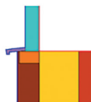
Figura 4: Puentes térmico lineal del encuentro de la fachada Structura con el frente del forjado.
